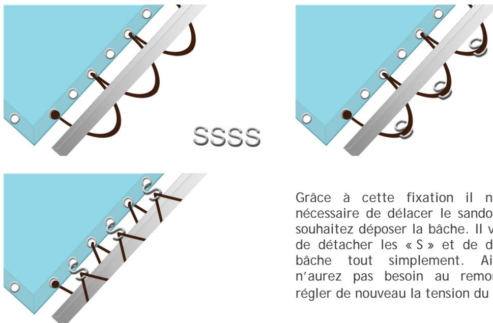
Grâce à cette fixation il n'est plus nécessaire de délayer le sandow si vous souhaitez déposer la bâche. Il vous suffit de détacher les « S » et de déposer la bâche tout simplement. Ainsi vous n'aurez pas besoin au remontage de régler de nouveau la tension du sandow.
